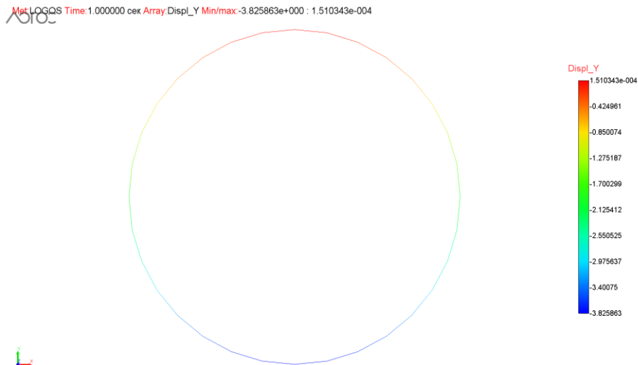
Рис. 22. Поле перемещений в балке по оси Y (м)
